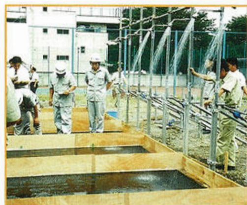
試験体への散水状況
